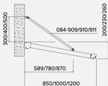
Système modulaire en aluminium qui se caractérise pour la simplicité de montage, à installer sur place, et pour la qualité des matériaux. Gouttière frontale bien intégrée dans le profilé avant pour diriger l'eau dans les évacuations latérales. Peinture aux poudres polyester réalisée selon de strictes normes de qualité, couverture en polycarbonate de 4 mm d'épaisseur, type ignifuge dassel. De 85 à 120 cm de saillie.
