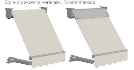
Store fonctionnant avec rappel par ressort, avec treuil ou moteur, avec bras en saillie de 60 cm. Possibilité d'application au mur ou plafond avec plaques en aluminium moulé sous pression. Visserie exposée en acier inox. Peinture avec poudres polyester effectuée en conformité aux normes de qualité strictes. Possibilité de couverture avec coffre pour une protection complète du tissu. Structure indiquée pour les côtés sur balcons et fenêtres. Largeur max 4.00 m.
