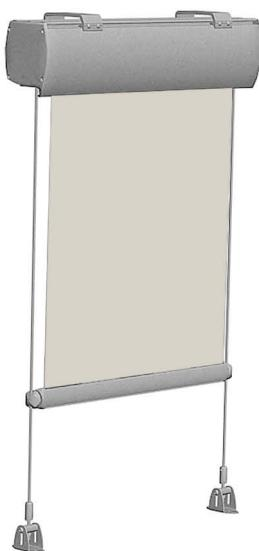
Store modulaire de type vertical avec coffre au design soigné et compact, particulièrement indiqué pour fenêtres, balcons, et façades continues. Actionnement manuel par treuil avec possibilité de motorisation. L'unité est guidée par des câbles en acier ø 5 mm, applicables sur rebords de fenêtres, sols, balustrades ou murs. Possibilité d'application murale ou au plafond. Largeur max : 400 x 300cm h.
