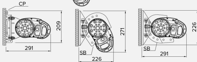
Fixation au plafond . Deckenbefestigung
