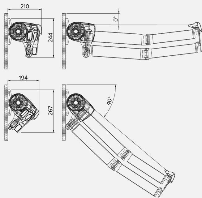
Fixation au plafond . Deckenbefestigung
