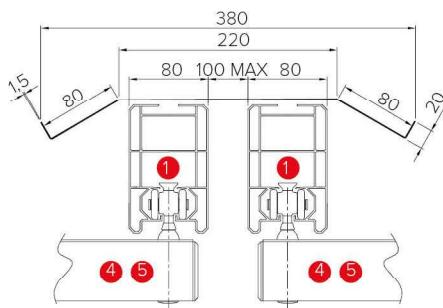
Détail de l'auvent . Detailansicht des Schutzdaches
