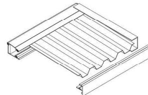
Profils périmétraux en aluminium extrudé et support frontal de cm. 13x8.
